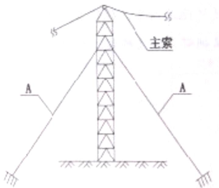
图 1 塔架示意图
